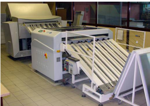
Novgeneracia CTP-maŝino por komputila pretigo de ofsetaj presplatoj kaj moderna diĝita presmaŝino, kiu garantias altkvalitajn plenkolorajn produktojn.
